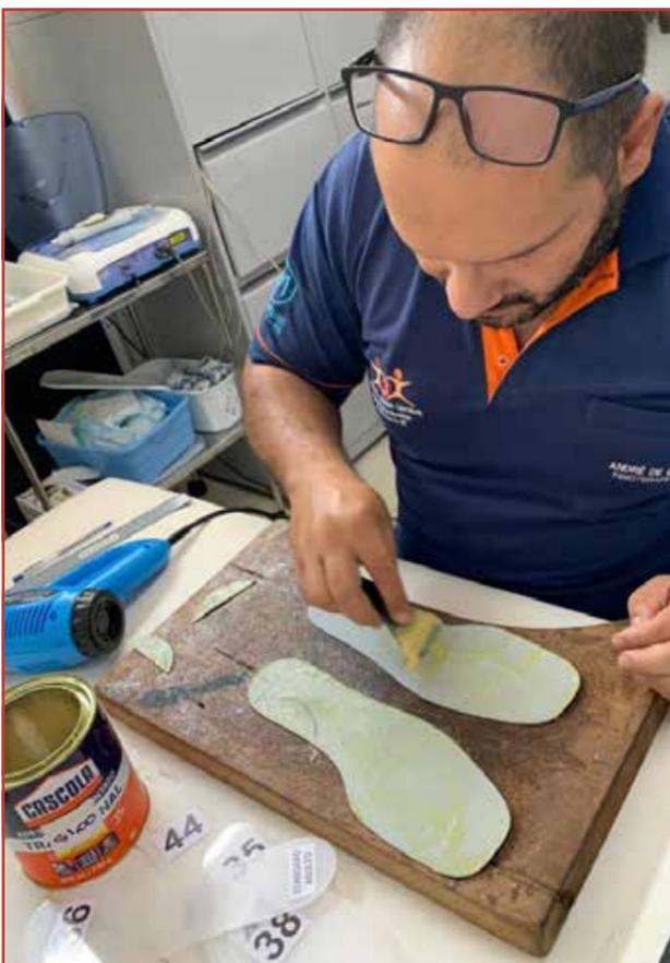
Fabrication de semelles orthopédiques sur mesure
